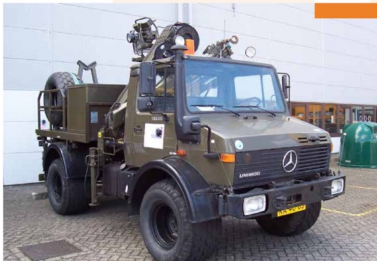
Unimog U 1450 van de Marine met AutoLaadKraan. Wordt gebruikt voor lichte hijs- en afmeerwerkzaamheden. Let op de breedte van de band.
