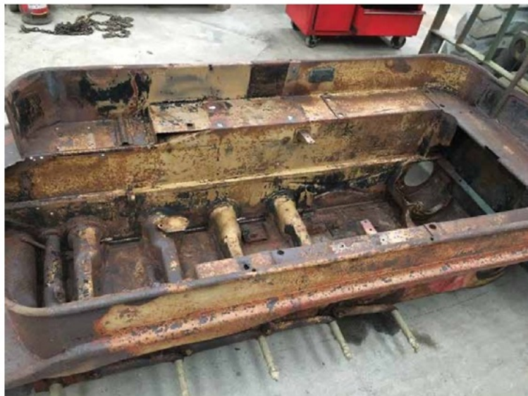
De uit plaatstaal gemaakte chassis-kuip.
